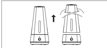
2. 水タンクを裏返し、給水キャップを反時計回りに回し外してください。
