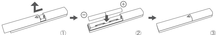
1. リモコンの電池カバーをスライドさせてから上に持ち上げて取り外します。
